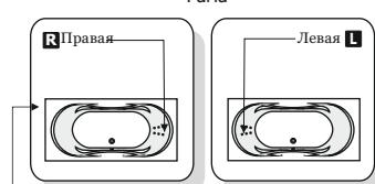
На симметричных ваннах в комплектациях **Basic** и **Optima** установка форсунок для массажа спины производится на правом борту ванны (**R**) или на левом борту (**L**).
